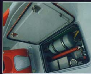
A gauche l'énorme boîte à eau, au milieu l'arbre de transmission, à droite le réservoir.
