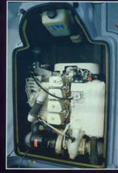
Sous la selle, le compartiment moteur avec un bloc Turbo Diesel de 240 CV
